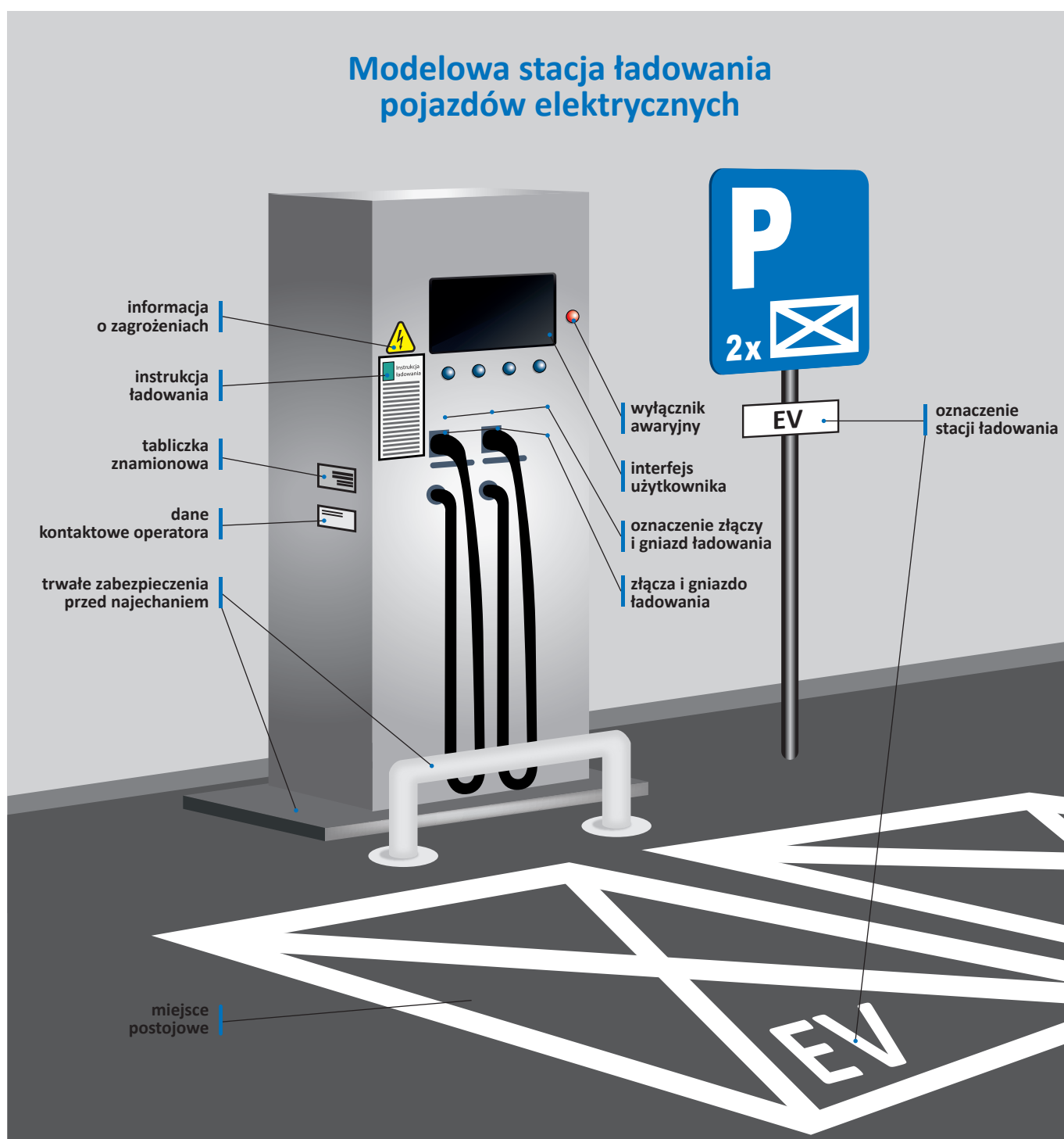
Rys. 2 Modelowa stacja ładowania pojazdów elektrycznych
